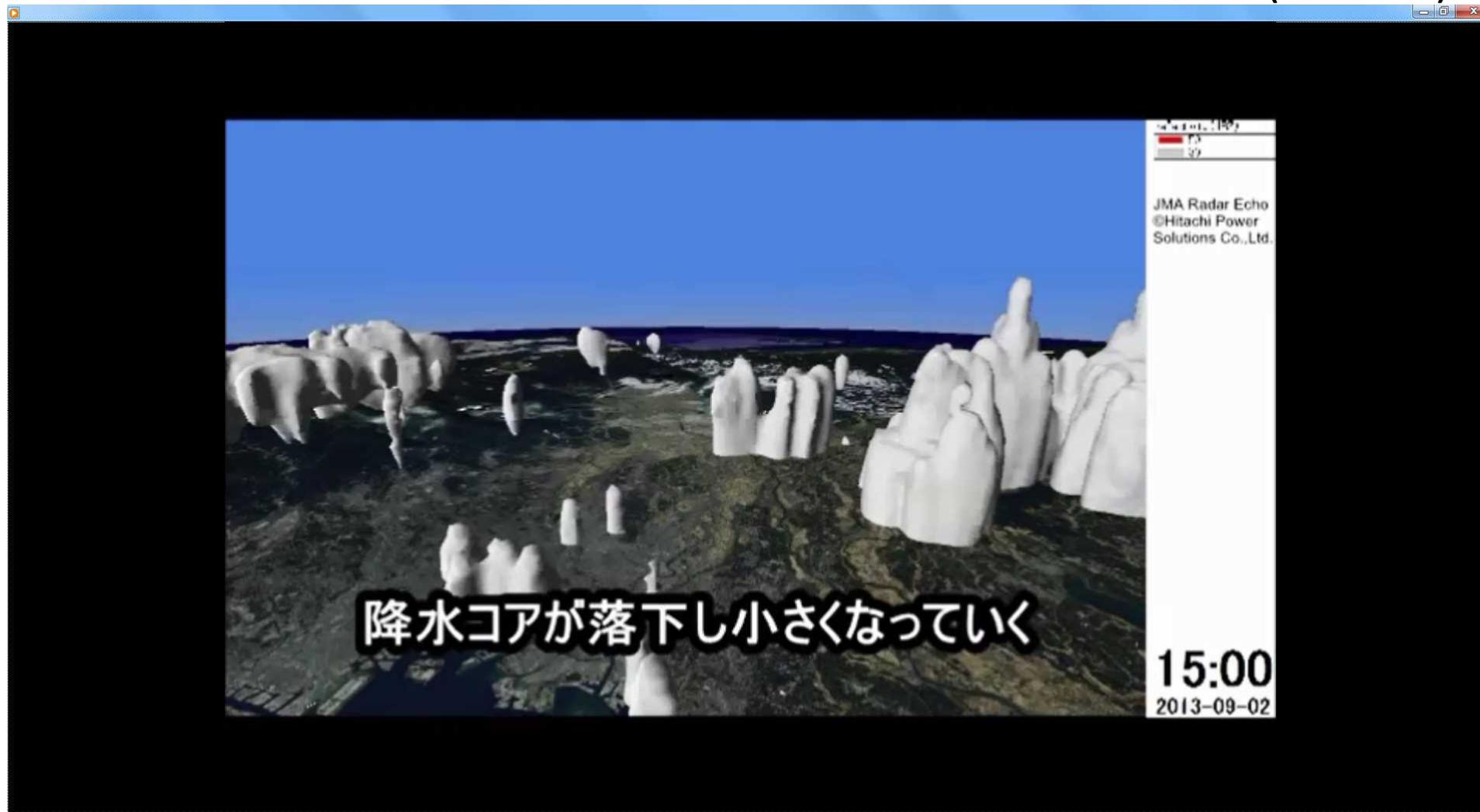
気象庁レーダーデータ(エコー強度)をCAPPI(Constant Altitude Plan Position Indicator)に変換。
