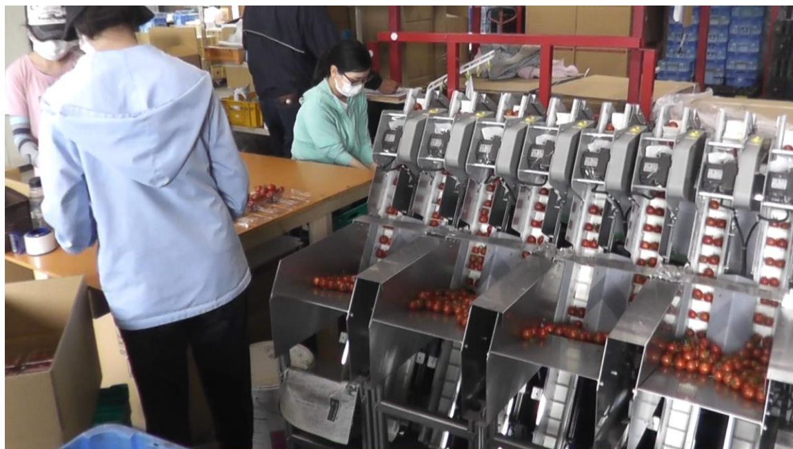
ミニトマトの自動計量器
